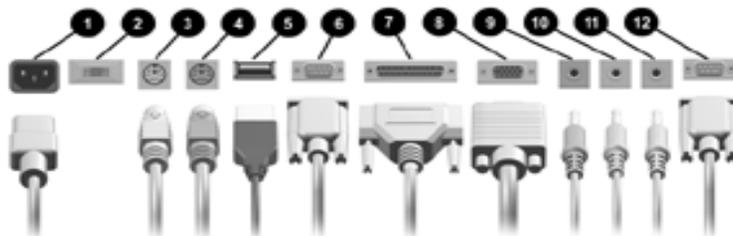
*Conectores do painel traseiro (a disposição dos conectores pode variar de acordo com o modelo).*
