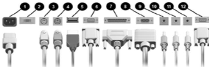
Conectores do painel posterior (A disposição dos conectores poderá variar de acordo com o modelo.)
