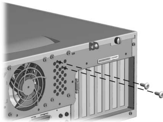
スマート カバー ロックのネジの取り外し
