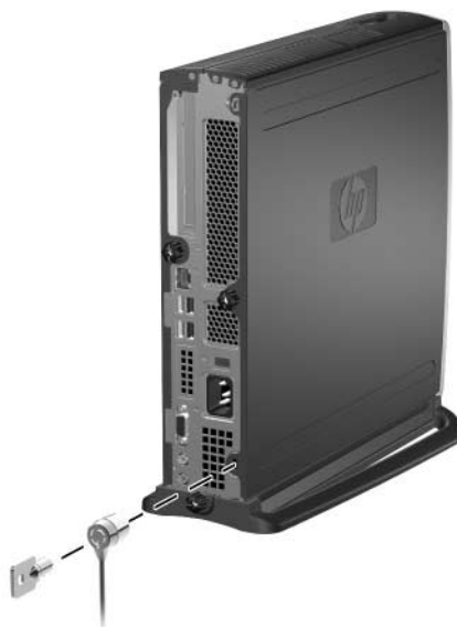
Installation d'un dispositif antivol
