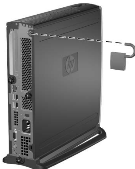
Instalación de un candado
