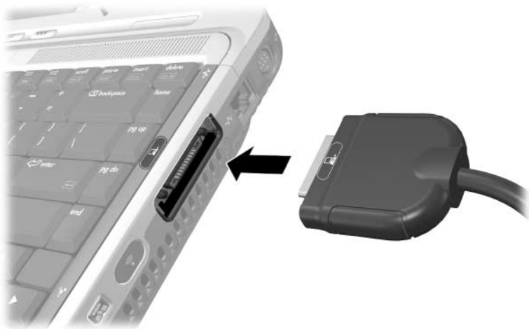
Uitbreidingskabel aansluiten op de notebookcomputer
