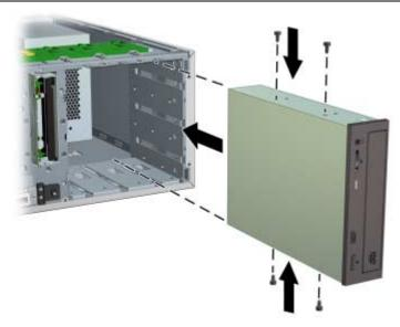
6. オプティカルドライブをドライブベイにスライドさせて完全に押し込み、ドライブを固定します。ワークステーションの機種によっては、新しいドライブをスライドさせる際に、オプティカルドライブケージの左側のばね付きラッチを持ち上げる必要があります。
