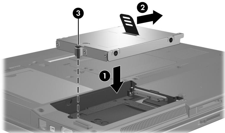
4. 将硬盘驱动器盖上的卡舌 ① 对准笔记本计算机上的相应槽口。
