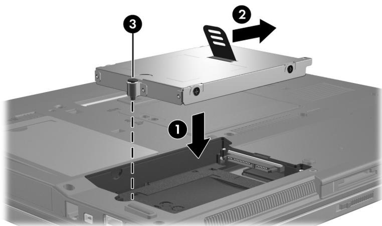
4. 将硬盘驱动器盖上的卡舌 ❶ 对准笔记本电脑上的相应槽口。
