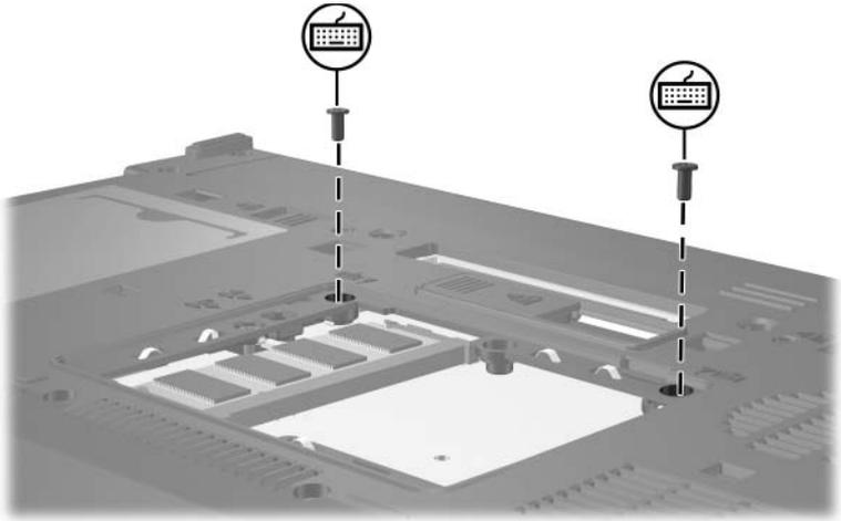
19. Richten Sie die Führungsnasen der Speichermodulabdeckung an den Schlitten für die Abdeckung am Computer aus ❶.
