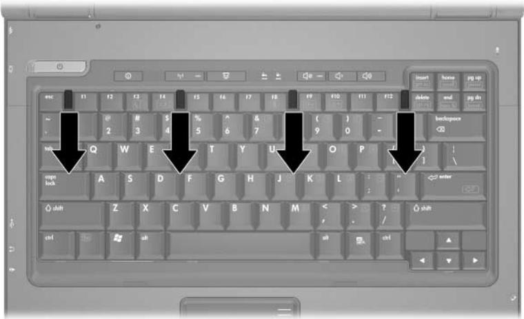
12. Levante el borde superior del teclado suavemente e incline el teclado hasta que se apoye en el apoya muñecas del equipo.
