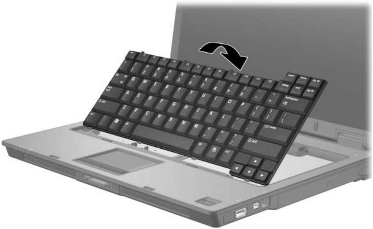
16. Deslice los cuatro pestillos para trabar el teclado.
