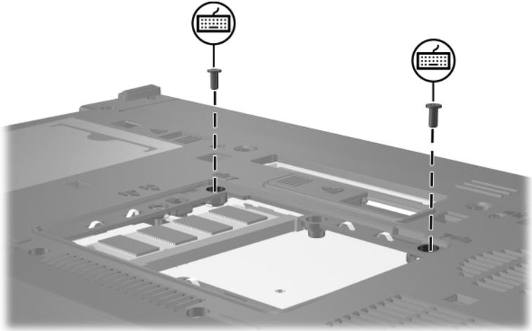
19. Alinee las pestañas ❶ de la cubierta del compartimento del módulo de memoria con las muescas del equipo.
