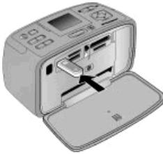
Wenn Sie den optionalen HP Bluetooth Wireless-Druckeradapter an den Kameraanschluss des Druckers anschließen, müssen Sie die entsprechenden Optionen unter [Tools](#) festlegen.
