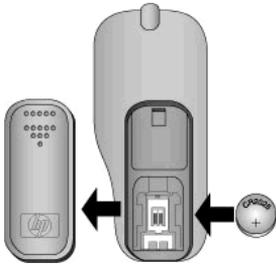
1. Öffnen Sie die Abdeckung des Batteriefachs auf der Rückseite der Fernbedienung.
