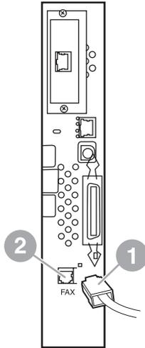
11. Pasang ujung kabel telepon yang lainnya ke soket telepon di dinding. Tekan konektor hingga Anda mendengar bunyi klik atau konektor telah terpasang dengan aman. Karena terdapat berbagai jenis konektor, bunyi klik mungkin terdengar atau tidak saat konektor dipasang, tergantung pada negara/kawasan.
