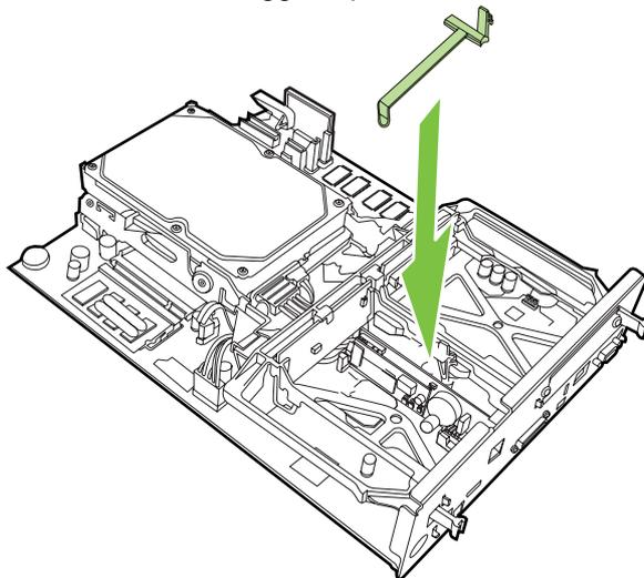
11. Mengencangkan tab di sisi kanan penahan kartu faks.
