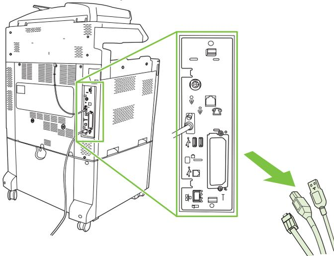
3. Tekan tab hitam di bagian atas dan bawah ke arah bagian tengah panel pemasangan, kemudian tarik panel secara perlahan dari MFP. Letakkan panel pemasangan di atas permukaan yang bersih, rata, dan telah diarde.
