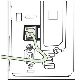
**CATATAN:** Pastikan Anda memasang kabel telepon ke port aksesori faks yang terdapat di dekat bagian atas panel pemasangan. Jangan sambungkan saluran telepon ke port LAN HP Jetdirect yang berada lebih dekat ke bagian bawah panel pemasangan.
