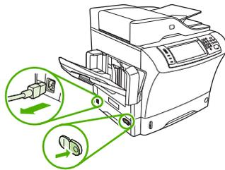
3. Lepaskan penutup samping di bagian belakang perangkat dengan meletakkan jari Anda di lekukan dan menggeser penutup hingga terlepas.
