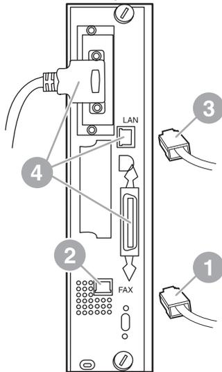
10. Pasang ujung kabel telepon yang lainnya ke soket telepon di dinding. Tekan konektor hingga Anda mendengar bunyi klik atau konektor telah terpasang dengan benar. Karena terdapat berbagai jenis konektor, bunyi klik mungkin terdengar atau tidak saat konektor dipasang, tergantung pada negara/kawasan Anda.
