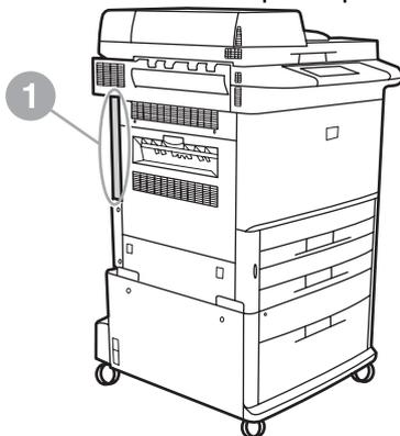
4. Lepaskan semua kabel (2) dari panel pemasangan (1). Ingat posisi kabel sebelum dilepas agar Anda dapat memasangnya kembali ke tempat yang sama.
