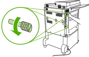
4. Lepaskan sekrup, kemudian keluarkan panel pemasangan dari MFP. Letakkan panel tersebut di atas permukaan isolator yang rata.
