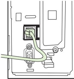
**CATATAN:** Pastikan Anda menyambungkan saluran telepon ke port aksesori faks di dekat bagian atas panel pemasangan. Jangan hubungkan saluran telepon ke port LAN HP Jetdirect yang ada di dekat bagian bawah panel pemasangan.
