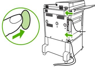
**CATATAN:** Saat menyambungkan aksesori faks ke saluran telepon, pastikan saluran telepon yang digunakan untuk aksesori faks adalah saluran khusus yang tidak digunakan oleh perangkat lain. Saluran ini juga harus merupakan saluran analog karena faks tidak akan berfungsi dengan benar jika disambungkan ke beberapa sistem PBX digital. Jika Anda ragu terhadap saluran telepon yang dimiliki (analog atau digital), hubungi perusahaan telekomunikasi Anda.
