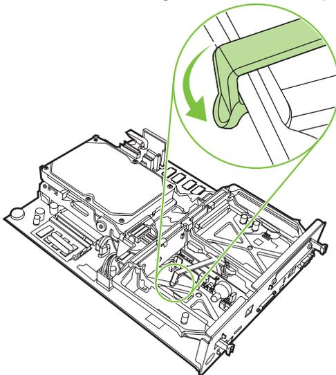
13. Luruskan panel pemasangan di bagian atas dan bawah jalur, kemudian geser kembali panel ke dalam MFP. Tekan tab hitam pada panel pemasangan ke arah luar hingga terpasang kembali dengan benar pada posisinya.
