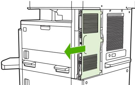
4. Bila perlu, lepaskan penutup plastik aksesori faks dari panel pemasangan. Masukkan koin ke dalam celah di bagian atas penutup, kemudian lepaskan penutup dari panel pemasangan.
