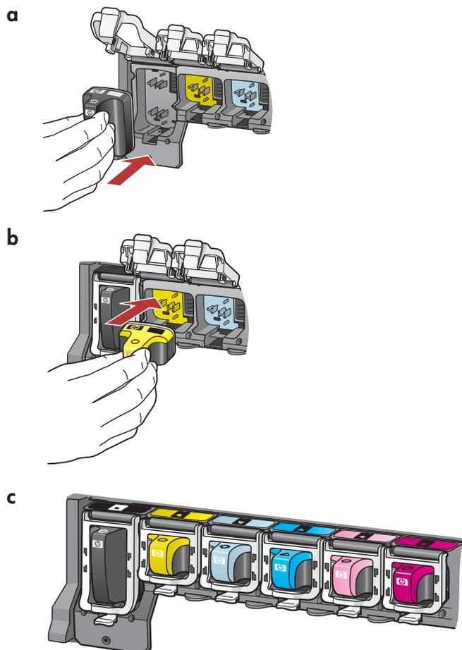
Corresponda a cor e o padrão do cartucho de tinta à cor e ao padrão do carro de impressão.
