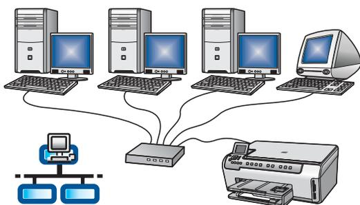
Utilize esse tipo de conexão se desejar uma conexão por cabo Ethernet entre o dispositivo e a rede.
