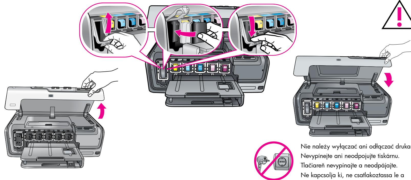
**Ważne!** Jednorazowy proces inicjowania rozpoczyna się po zainstalowaniu pojemnika z tuszem. Odgłosy pracy mechanizmu są zjawiskiem normalnym i trwają około 4 minut. Nie należy wyłączać ani odłączać drukarki. Jeśli inicjowanie zostanie przerwane, należy zapoznać się z sekcją Podręcznika użytkownika na dysku CD poświęconą rozwiązywaniu problemów.
