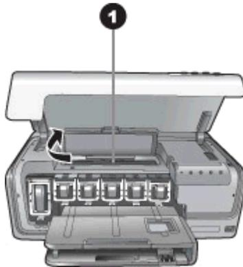
1. Ouvrir la porte d'accès au bourrage papier pour dégager les têtes d'impression.
