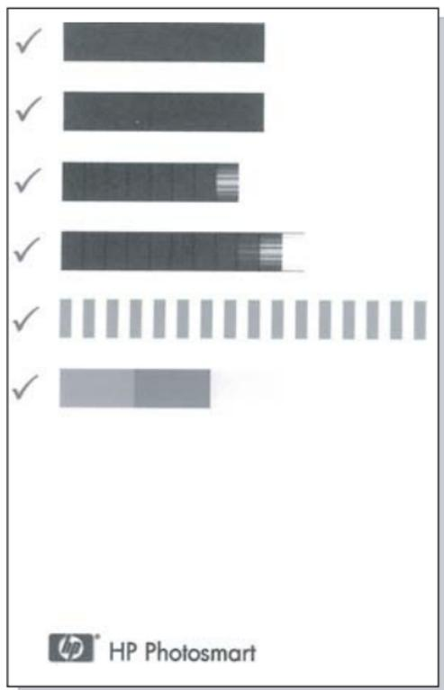
An den Häkchen ist zu erkennen, dass die Druckpatrone ordnungsgemäß eingesetzt ist und richtig funktioniert. Wenn links neben einem Balken ein "x" zu sehen ist, richten Sie die Druckpatrone erneut aus.
