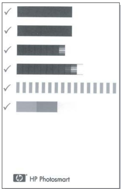
Las marcas de verificación comprueban que el cartucho está instalado correctamente y funciona de forma adecuada.
