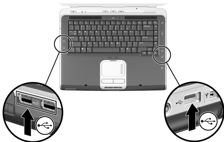
识别左侧的两个 USB 连接器与右侧的一个 USB 连接器
