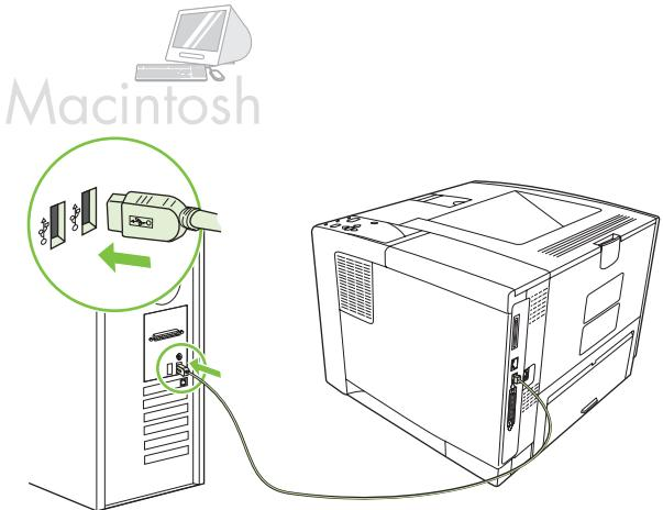
**13.2)** 連接印表機與電腦之間的 USB 電纜。注意：HP 不建議使用 USB 集線器。使用長度 2 公尺 (6.5 英呎) 以下的 USB 電纜。
