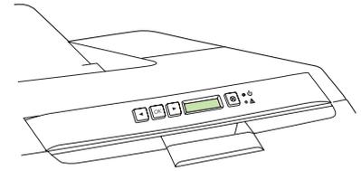
كوّن عنوان IP، إذا دعت الحاجة. في لوحة تحكم الطابعة، اضغط OK، واضغط زر > أو < لتحديد Network Config، ثم اضغط OK. اضغط زر > أو < لتحديد TCP/IP Config، ثم اضغط OK.
