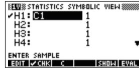
La primera columna indica la columna de datos asociada a cada definición de conjunto de datos y la segunda columna indica la frecuencia constante o la columna que contiene las frecuencias.
