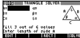
*Nota:* si ya ha utilizado Triangle Solver, se continuarán mostrando las entradas y resultados del uso anterior. Para iniciar Triangle Solver en limpio, pulse **SHIFT CLEAR** para borrar las entradas y resultados anteriores.
