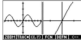
– Las teclas del menú Plot se encuentran disponibles igual que para la representación completa (para el trazado, la visualización de coordenadas, la visualización de ecuaciones, etc.).
