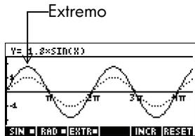
Si pulsa **[SYMB]**, se visualizará la ecuación en la parte superior de la pantalla. La ecuación controla el gráfico. Las teclas **[▶]** y **[◀]** permiten el desplazamiento entre parámetros. Para cambiar los valores de un parámetro, utilice las teclas **[▲]** y **[▼]**.
