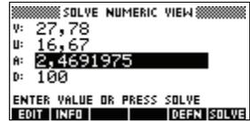
Por tanto, la aceleración necesaria para aumentar la velocidad de un automóvil de 16,67 m/seg (60 kph) a 27,78 m/seg (100 kph) en una distancia de 100 m es aproximadamente  $2,47 \text{ m/s}^2$ .
