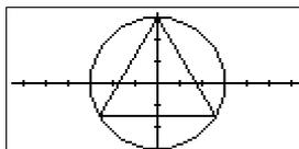
En lugar del círculo, se visualizará un triángulo (sin modificar la ecuación), ya que el valor modificado de TSTEP garantiza que los puntos trazados tienen una separación de 120°, en lugar de ser casi continuos.
