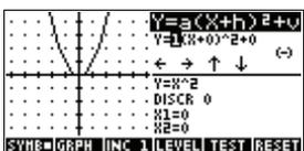
Para desplazarse por los parámetros, pulse las teclas **▶** y **◀** y para cambiar sus valores, utilice las teclas **▲** y **▼**.
