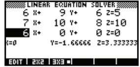
A medida que se introducen los siguientes valores desconocidos, la solución cambia. El ejemplo de la derecha muestra la solución final una vez introducidos todos los coeficientes y constantes para el sistema de ecuaciones que queríamos resolver.
