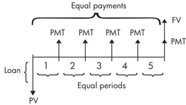
Además, los diagramas de flujo de caja especifican *cuándo* se abonan las cuotas en relación a los períodos compuestos: al *principio* de cada período o al *final*. La aplicación Ayudante financiero proporciona ambos modos de pago: modo de pago al principio o al final. El siguiente diagrama de flujo de caja muestra las cuotas por arrendamiento al *principio* de cada período.
