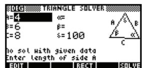
que los valores no sean coherentes, es decir, que no pueda existir ningún triángulo con todos los valores especificados. En estos casos, en la pantalla aparecerá No sol with given data.
