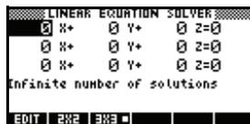
Si se muestra el formulario de entrada de tres ecuaciones y desea resolver un sistema de dos ecuaciones, pulse **2X2**.
