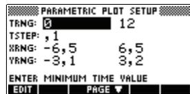
Verá que el formulario de entrada Plot Setup (configuración del trazado de gráficos) tiene dos campos no incluidos en el aplet Function, TRNG y TSTEP. TRNG especifica el rango de valores de  $t$ . TSTEP especifica el valor del incremento entre valores de  $t$ .
