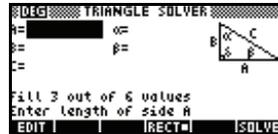
mostrará de nuevo este formulario de entrada (como en el ejemplo de la derecha). Si el triángulo que está examinando no es un triángulo rectángulo, o no sabe con seguridad de qué tipo es, debe utilizar el formulario de entrada general (ilustrado en el paso anterior). Para cambiar al formulario de entrada general, pulse **RECT**.
