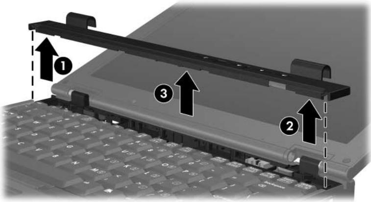
10. Levante suavemente el borde superior del teclado **1** para desacoplarlo del equipo.
