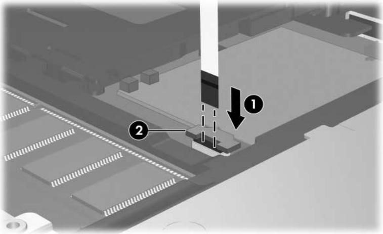
18. Presione hacia abajo los dos extremos del soporte del conector del dispositivo señalador de tipo palanca hasta que el cable vuelva a encajarse.
