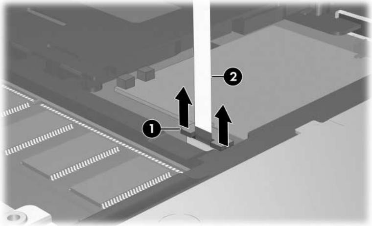
13. Desconecte el cable del dispositivo señalador de tipo palanca del conector del dispositivo señalador.
