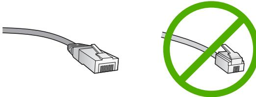
По внешнему виду стандартный кабель Ethernet не отличается от обычного телефонного кабеля, однако, эти кабели не являются одинаковыми. Они используют различное количество проводов и имеют разные разъемы.
