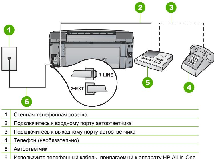
Настройте аппарат HP All-in-One для автоматического получения факсов и установите правильное значение параметра **Звонки до ответа**. Количество звонков до ответа, установленное на аппарате HP All-in-One, должно быть больше установленного на автоответчике. Если для автоответчика и аппарата HP All-in-One установлено одинаковое количество звонков до ответа, оба устройства примут вызовы, а факсимильные сигналы будут записаны на автоответчик.
