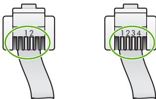
Если использовался 4-проводной телефонный кабель, отсоедините его, найдите входящий в комплект поставки 2-проводной телефонный кабель, а затем подсоедините 2-проводной телефонный кабель к порту 1-LINE на задней панели аппарата HP All-in-One.
