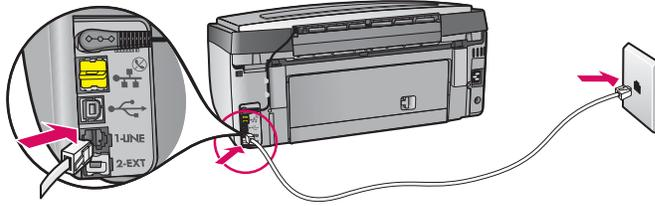
Verbinden Sie das eine Ende des mitgelieferten Telefonkabels mit dem Telefonanschluss **1-LINE** des Geräts und das andere Ende mit einer Telefonanschlussbuchse.
