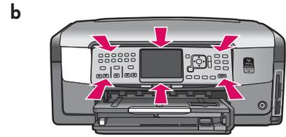
b Drücken Sie alle Kanten der Bedienfeldschablone **fest** nach unten, bis sie **einrastet**. Vergewissern Sie sich, dass alle Tasten durch die Öffnungen ragen.
