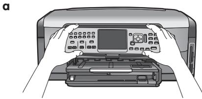
a Legen Sie die Bedienfeldschablone über die Bedienelemente des Geräts.
