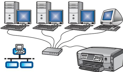
Verwenden Sie diesen Verbindungstyp, wenn Sie das Gerät über ein Ethernet-Kabel mit einem Netzwerk verbinden möchten.
