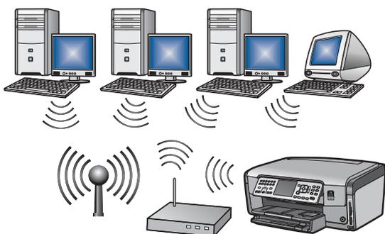
Χρησιμοποιήστε αυτόν τον τύπο σύνδεσης, αν θέλετε να κάνετε μια ασύρματη σύνδεση (802.11 β ή ζ) ανάμεσα στο HP All-in-One και το δικτύό σας.
