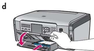
**d** Опустите выходной лоток и задвиньте в лоток для фотобумаги.
