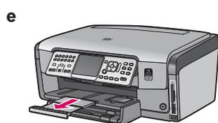
**e** Выдвиньте расширитель лотка и поднимите держатель для бумаги.
