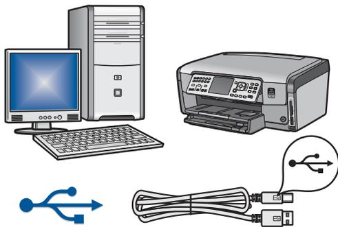
如果您要将 HP All-in-One 直接连接至一台计算机，请使用这种连接类型。（请勿在执行步骤 A2 前连接 USB 电缆）。
