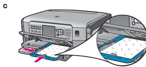
c 从样品包装内取出 4 x 6 英寸 (10 x 15 cm) 照片纸装入照片盒，并使光滑面向下。
