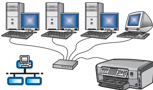
如果您要在 HP All-in-One 和网络之间使用 Ethernet 电缆连接，请使用这种连接类型。
