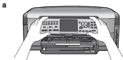
a 将控制面板贴片放在设备的按钮上。
