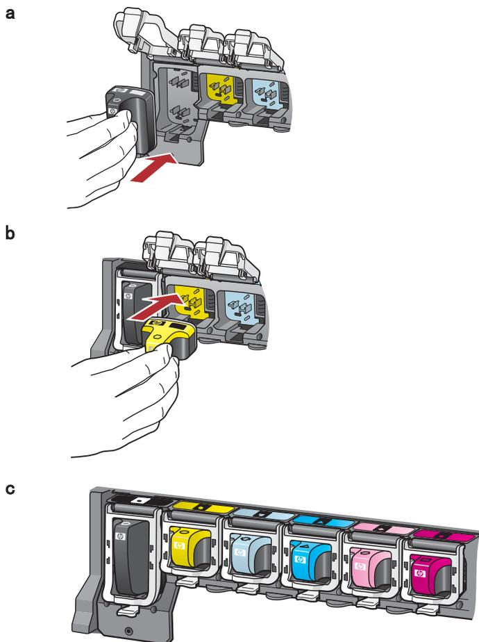
将墨盒的颜色与图案同打印支架的颜色与图案匹配。
