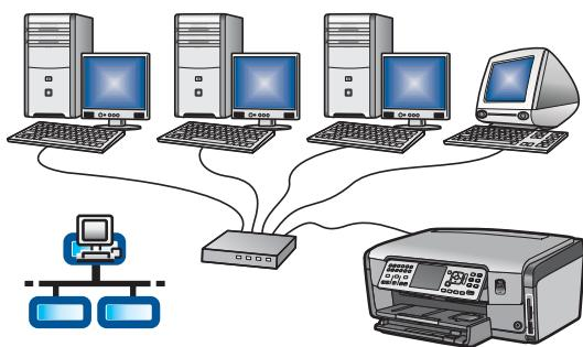
Izmantojiet šo savienojuma veidu, lai ierīci HP All-in-One pievienotu tīklam ar Ethernet kabeli.
