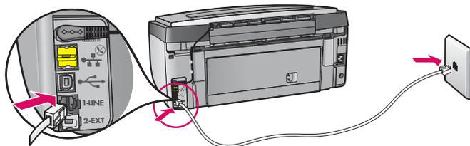
Під'єднайте один кінець телефонного шнура до телефонного порту з написом **1-LINE**, а інший — до телефонної розетки.
