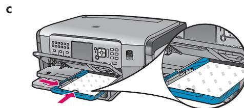
**c** Завантажте фотопапір розміром 10 x 15 см (4 x 6 дюйми) із комплекту зразків глянцевою стороною донизу в лоток для фотопаперу.
