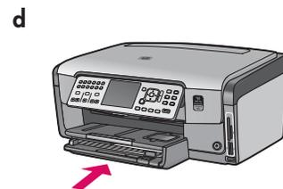
Завантажте звичайний білий папір у нижній лоток для паперу. Звичайний папір потрібен для юстування пристрою.
