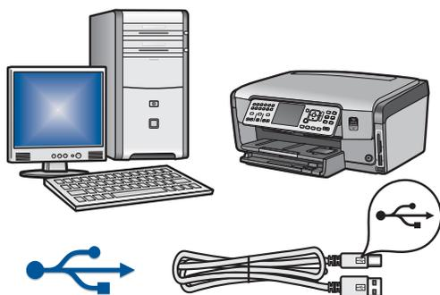
Використовуйте цей тип з'єднання, якщо слід підключити пристрій HP All-in-One безпосередньо до одного комп'ютера. **(Не під'єднуйте USB-кабель до виконання кроку А2).**
