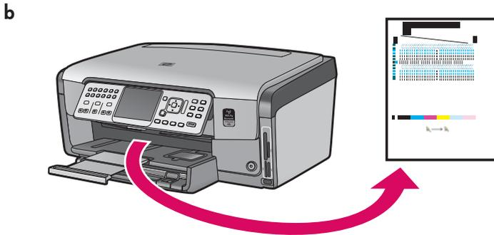
**b** Юстування завершується після друкування юстувальної сторінки. Перевірте поточний стан на дисплеї та натисніть кнопку **OK**. Надруковану сторінку юстування можна викинути або здати на переробку.
