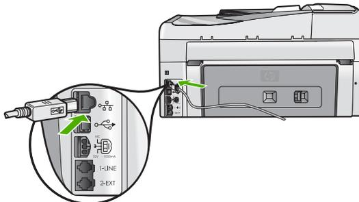
3. Connectez l'autre extrémité du câble Ethernet à un port disponible sur votre routeur ou commutateur Ethernet.
