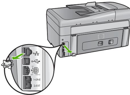
2. Connectez le câble Ethernet au port Ethernet à l'arrière de l'appareil Tout-en-un HP.
