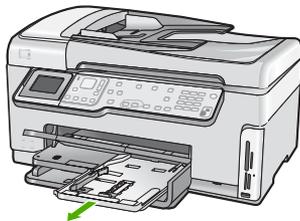
3. Insérez la pile de papier photo dans le bac d'alimentation photo dans le sens de la longueur et face papier glacé vers le bas. Faites-la glisser jusqu'à ce qu'elle soit calée.
