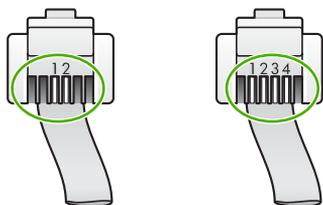
Si vous utilisez un cordon téléphonique à 4 fils, déconnectez-le, puis connectez le cordon téléphonique à 2 fils au port 1-Ligne à l'arrière de l'appareil Tout-en-un HP.
