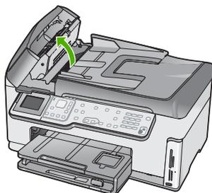
Une bande de verre se trouve en dessous du mécanisme du bac d'alimentation automatique.
