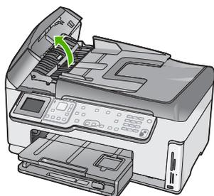
3. Soulevez le mécanisme du bac d'alimentation automatique.
