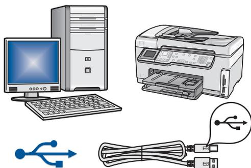
Χρησιμοποιήστε αυτόν τον τύπο σύνδεσης, αν θέλετε να συνδέσετε το HP All-in-One απευθείας σε έναν υπολογιστή. **(Μην συνδέσετε το καλώδιο USB μέχρι το βήμα A2).**
