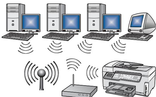
Χρησιμοποιήστε αυτόν τον τύπο σύνδεσης, αν θέλετε να κάνετε μια ασύρματη σύνδεση (802.11 β ή ζ) ανάμεσα στο HP All-in-One και το δίκτυό σας.
