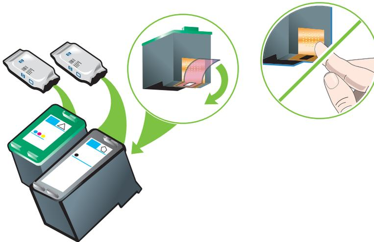
4. Sujete el cartucho de impresión con los contactos de cobre hacia la impresora y, a continuación, deslice el cartucho de impresión en la base.
