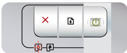
El cartucho de impresión tricolor está dañado o no está instalado.
