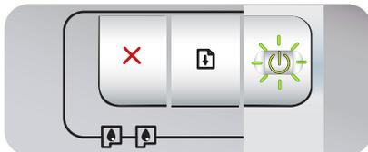
La impresora está imprimiendo o procesando un trabajo de impresión.
