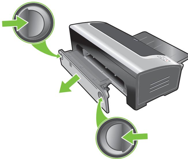
3. 양면 인쇄 장치(설치된 경우)의 후면 덮개를 제거하고 종이가 있으면 제거한 후, 후면 덮개를 다시 제자리에 놓습니다. 후면 덮개를 제거해도 걸린 용지가 보이지 않으면 자동 양면 인쇄 장치를 떼어낸 후 용지 걸림 위치를 찾아보십시오.
