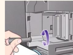
5. Una vez que haya insertado la tarjeta, ajuste los tornillos en su sitio utilizando sus dos tornillos (en la parte superior e inferior de la tarjeta). Igualmente, esto se puede hacer con un destornillador o manualmente.
