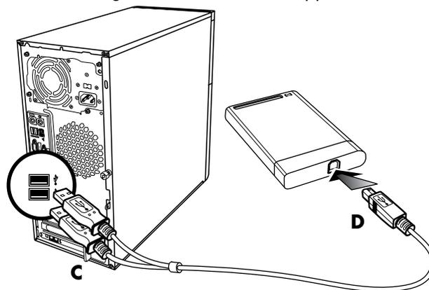
**REMARQUE :** Le système USB 2.0 utilise un seul connecteur USB. Les systèmes USB 1.x utilisent les deux connecteurs USB.
