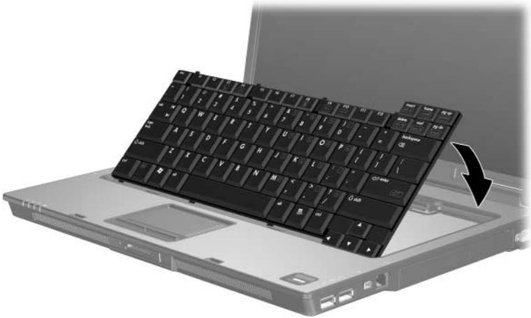
16. Schieben Sie die vier Tastaturverriegelungen zu, um die Tastatur zu verriegeln.
