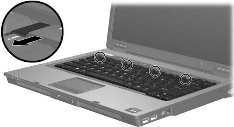
12. Heben Sie den hinteren Rand der Tastatur vorsichtig an, und kippen Sie die Tastatur um, so dass sie auf der Handablage des Computers aufliegt.
