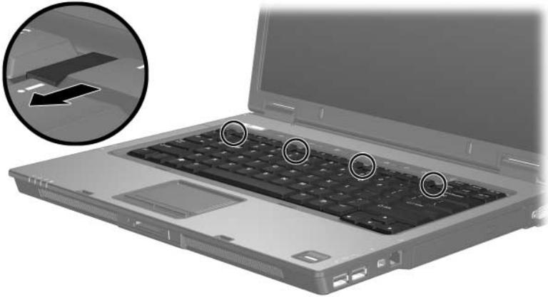
12. キーボードの上端部分をゆっくり持ち上げて、コンピュータのパームレストに乗るまで回転させます。
