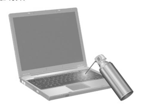
コンピュータのキーボードにポインティングスティックがある場合、定期的に清掃してスティックパッドを交換する必要があります(交換用スティックパッドは一部のモデルに付属しています)。
