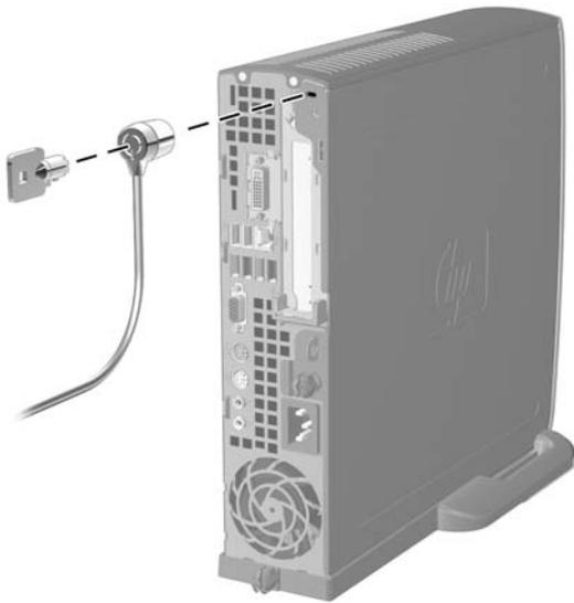
**Figura C-1** Instalación de un Bloqueo de cable
