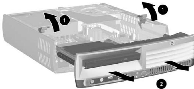
**Figura 2-5** Extracción del panel frontal
