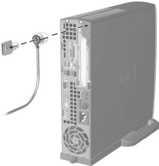
**Figure C-1** Installation d'un câble de sécurité
