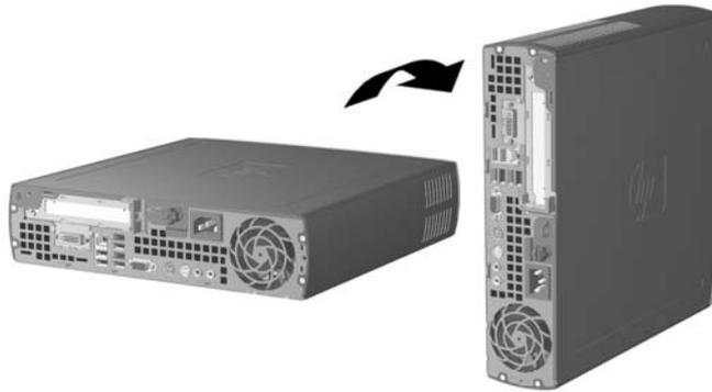
5. Abaissez l'ordinateur sur le socle afin que les crochets sur l'avant de la tour tiennent dans les aérations au bas de l'ordinateur, puis faites glisser l'ordinateur jusqu'à ce que les crochets s'engagent (1).
