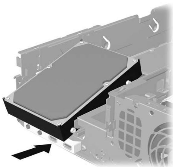
图 2-27 将驱动器装入 3.5 英寸驱动器托架（所示为硬盘驱动器）
