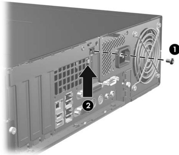
图 2-2 卸下智能机盖锁螺钉
