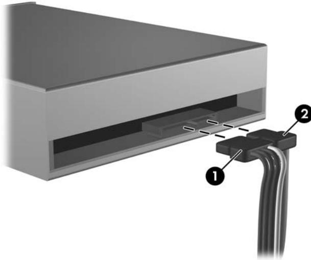
图 2-15 断开电源电缆和数据电缆
