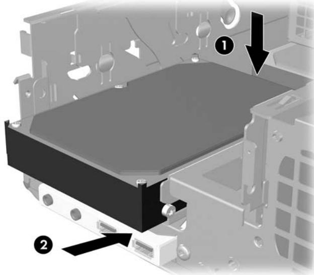
**图 2-28** 将驱动器装入 3.5 英寸驱动器托架（所示为硬盘驱动器）
