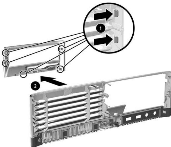
**图 2-29** 卸下驱动器面板（所示为软盘驱动器面板）
