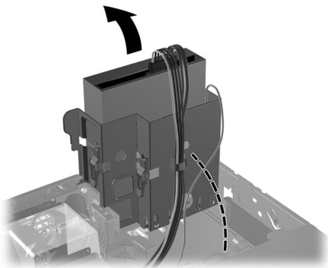
图 2-31 向上转动驱动器框架
