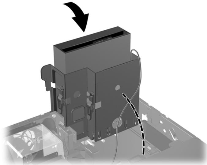
图 2-16 向下转动驱动器框架
