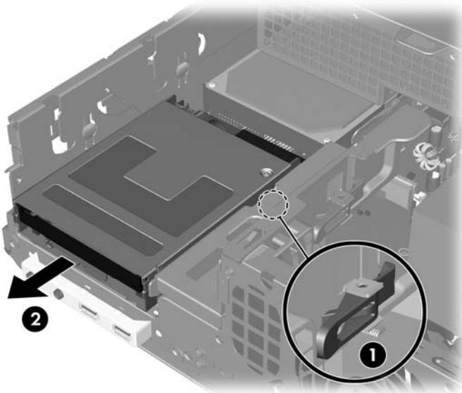
图 2-25 打开 3.5 英寸驱动器 (所示为软盘驱动器)
