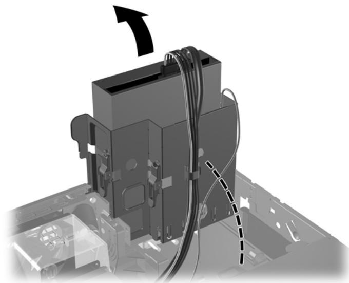
图 2-14 向上转动驱动器框架
