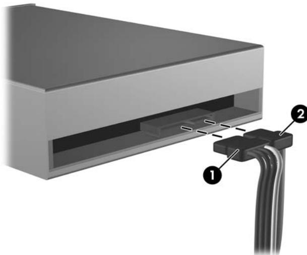
图 2-21 连接电源电缆和数据电缆
