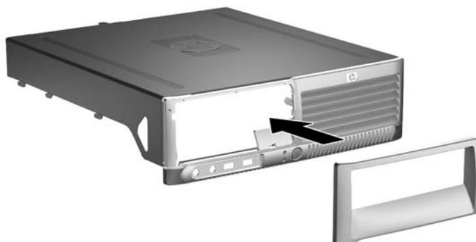
**图 2-30** 安装驱动器面板（所示为用于硬盘驱动器的空闲挡板）
