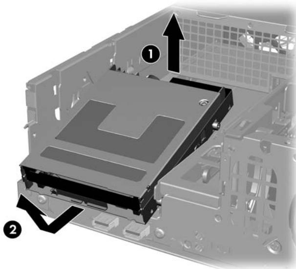
图 2-26 卸下 3.5 英寸驱动器 (所示为软盘驱动器)
