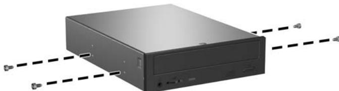
图 2-18 在光驱中安装导向螺钉
