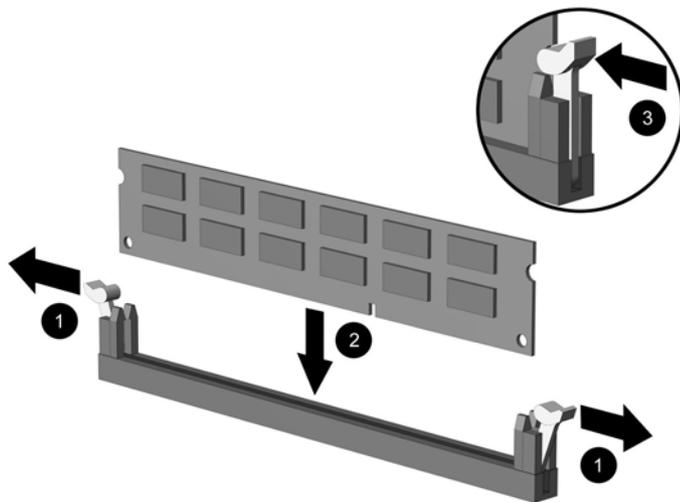
图 2-6 安装 DIMM
