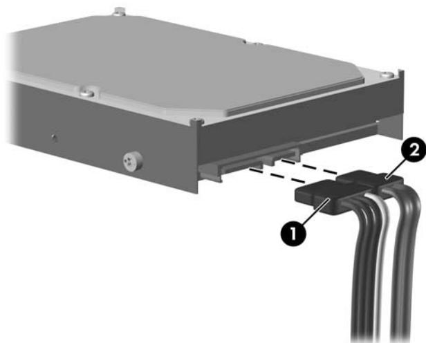
图 2-34 断开硬盘驱动器电源电缆和数据电缆
