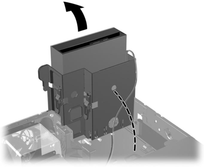
图 2-20 向上转动驱动器框架
