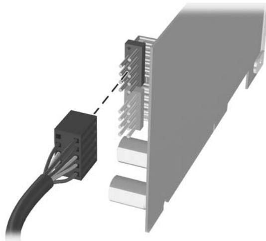
图 2-24 断开介质卡阅读器电缆
