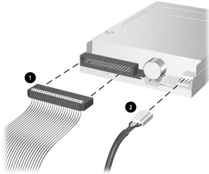
图 2-23 拔下软盘驱动器电缆
