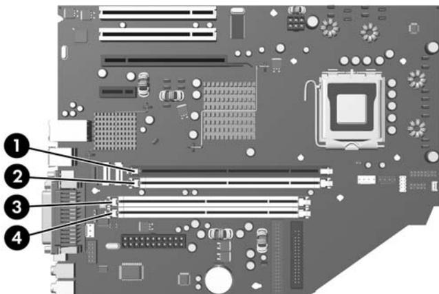
图 2-5 DIMM 插槽的位置
