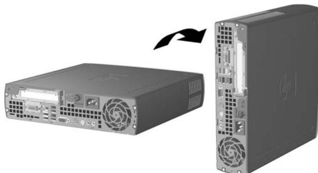
5. 縦置き用スタンドの前面のフックがコンピュータ底面の通気孔にはまるように、コンピュータをスタンドの上を下ろし、フックがかみ合うまでコンピュータを後方にスライドさせます (1)。
