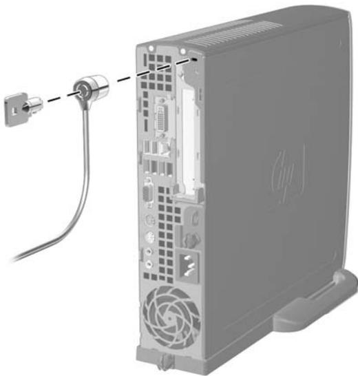
図 C-1 ケーブル ロックの取り付け
