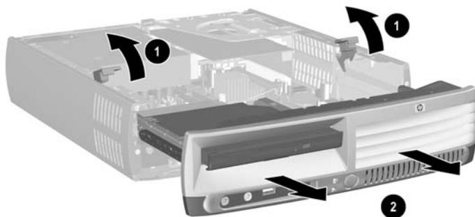
図 2-5 フロント パネルの取り外し
