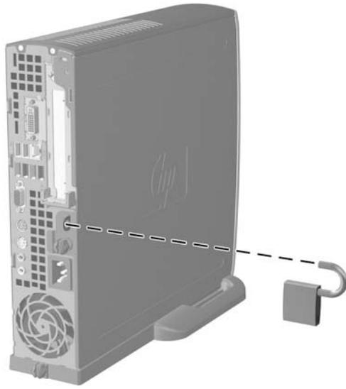
그림 C-2 패드락 설치
