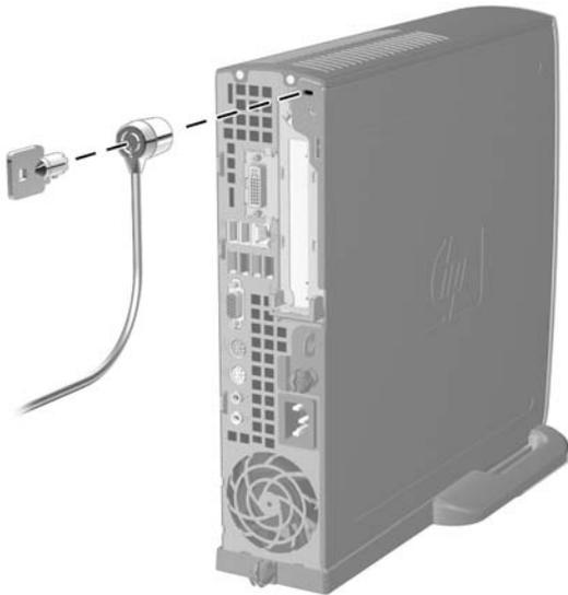
그림 C-1 케이블 잠금 장치 설치
