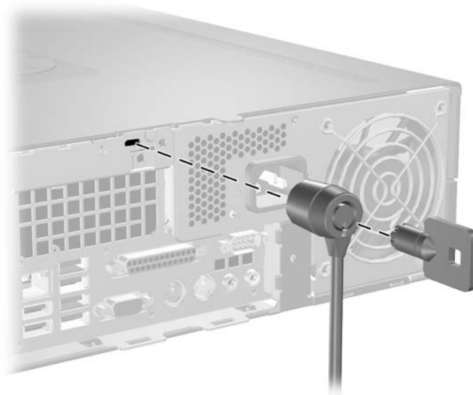
그림 C-1 케이블 잠금 장치 설치
