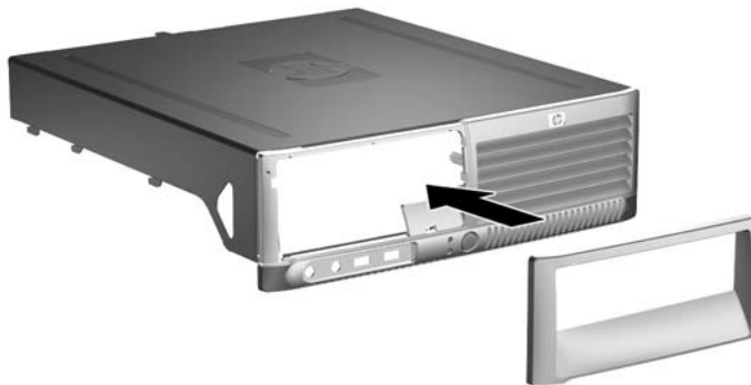
그림 2-30 드라이브 베젤 설치(위 그림은 하드 드라이브용 베젤 블랭크)
