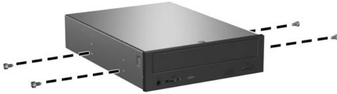
그림 2-18 광 드라이브에 유도 나사 설치
