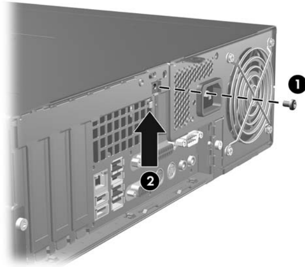
그림 2-2 Smart Cover Lock 나사 분리
