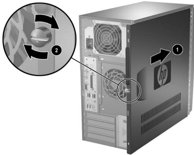
圖示 2-3 裝回電腦存取面板
