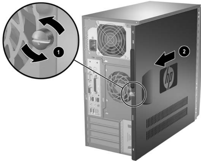
圖示 2-2 拆下電腦存取面板
