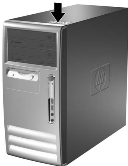
Рисунок 1-2 Розміщення серійного номера й ідентифікаційного коду виробу
