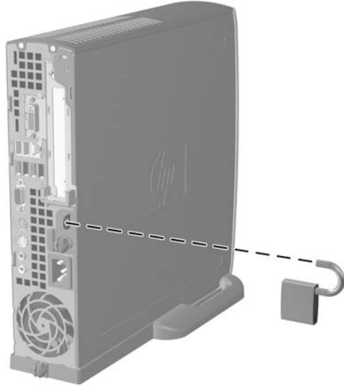
Şekil C-2 Asma Kilidin Takılması
