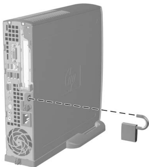
Obrázek C-2 Instalace visacího zámku
