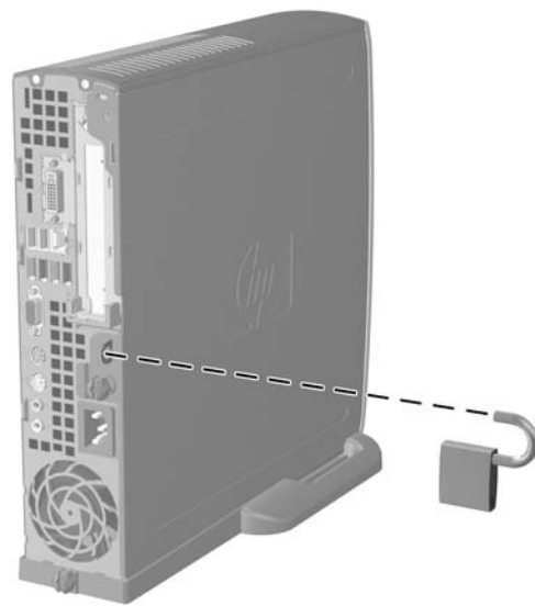
Figur C-2 Installation af en lås
