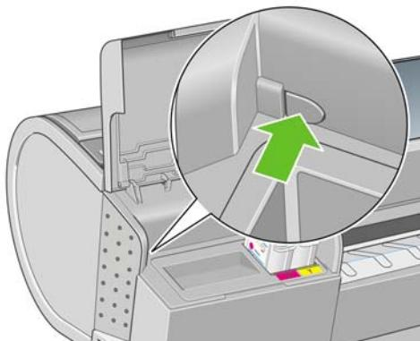
6. Снимите крышку в левой части принтера.
