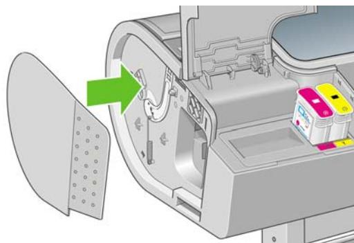
13. Закройте крышку отсека с картриджами.
