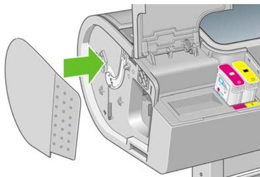
13. Закройте крышку отсека с картриджами.
