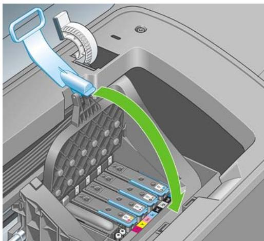
8. Проследите за тем, чтобы конец синей ручки зацепился за проволочную петлю на ближней стороне каретки.
