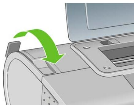
9. Закройте прозрачную крышку принтера.
