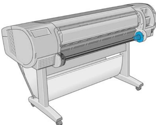
2. На каждом конце оси имеется ограничитель, удерживающий рулон в нужном положении. Синий ограничитель снимается при установке нового рулона и перемещается по шпинделю в соответствии с шириной используемого рулона. Снимите синий ограничитель бумаги с конца оси.
