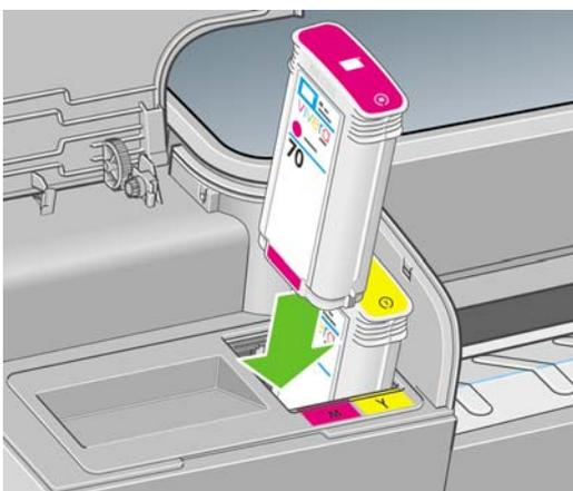
4. Вставьте картридж в гнездо и нажмите на него, чтобы он встал на место со щелчком. При этом будет подан звуковой сигнал, а на экране появится сообщение, подтверждающее установку картриджа.
