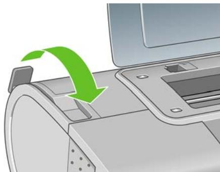
9. Закройте прозрачную крышку принтера.
