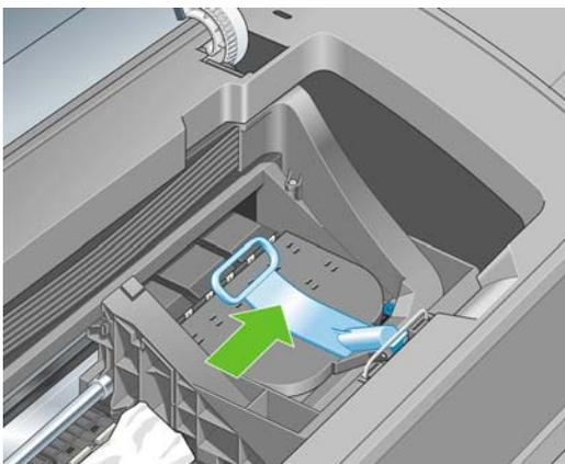
4. Поднимите синий рычажок вверх до упора.
