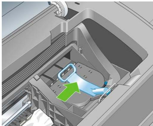
4. Поднимите синий рычажок вверх до упора.
