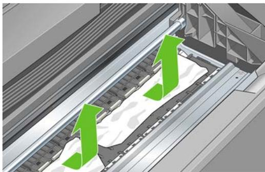
6. Стоя позади принтера, отмотайте рулон или вытяните отрезанный лист из принтера. Если бумага не видна, вернитесь к передней части принтера и удалите ее из выходного лотка.
