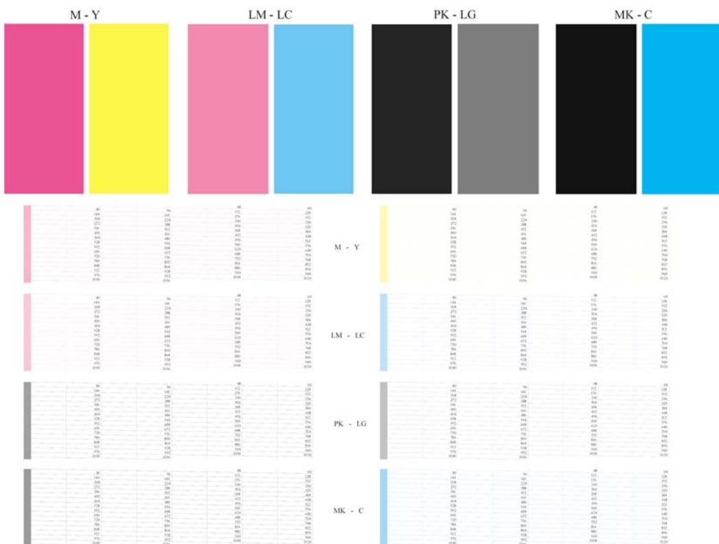
Сначала исследуйте верхнюю часть страницы (часть 1). Каждый прямоугольник должен быть окрашен равномерно, без горизонтальных полос.
