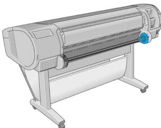
2. На каждом конце оси имеется ограничитель, удерживающий рулон в нужном положении. Синий ограничитель снимается при установке нового рулона и перемещается по шпинделю в соответствии с шириной используемого рулона. Снимите синий ограничитель бумаги с конца оси.
