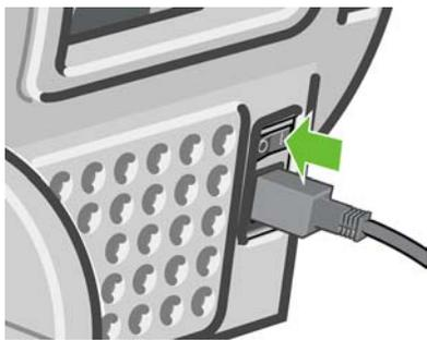
После включения питания принтеру требуется около трех минут для инициализации, а также проверки и подготовки печатающих головок. Подготовка печатающих головок занимает примерно 1 минуту 15 секунд. Но если принтер был долгое время выключен (шесть недель и более), подготовка головок может занять до 45 минут.
