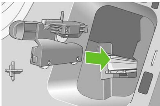
Два колесика в нижней части резака должны встать на центральный выступ рельсы, а два направляющих вкладыша — войти в паз в верхней части рельсы.
